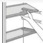
Con el fin de almacenar alimentos de diferentes tamaños, los balcones de la puerta pueden ser colocados a diferentes alturas. Para hacer este ajuste, proceda de la siguiente manera: Hale gradualmente en la dirección de las flechas hasta que este se libere. Luego, ubíquelo en la posición deseada.
