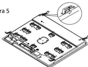
Coloque las patas de montaje como se muestra.
