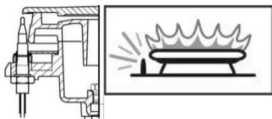
El aparato térmico activa el mecanismo de seguridad e inmediatamente apaga el gas si los quemadores superiores se apagan en caso de desbordamiento de líquido.
