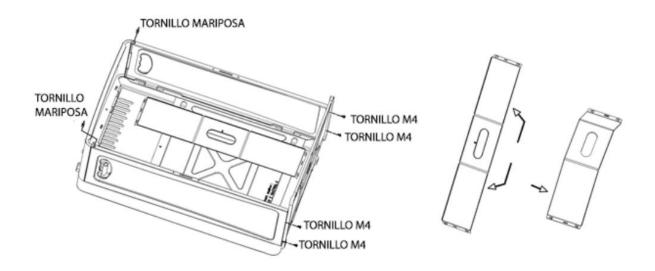
5. Conexión de los laterales izquierdo / derecho con la pieza superior mediante dos tornillos de mariposa. Fijación de los laterales izquierdo / derecho con la base inferior mediante 4 tornillos M4.
