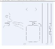
6. Si hay fuga de gas cierre la garrafa de gas. No desconecte el regulador. Apague todas las llamas. Revise las conexiones. Gire lentamente el gas y pase un cepillo humedecido con agua y jabón por las conexiones. Donde se formen burbujas hay una fuga de gas. Si se confirma la fuga de gas llame al servicio de emergencias. No use la estufa de nuevo hasta que haya sido inspeccionado por un técnico profesional.
