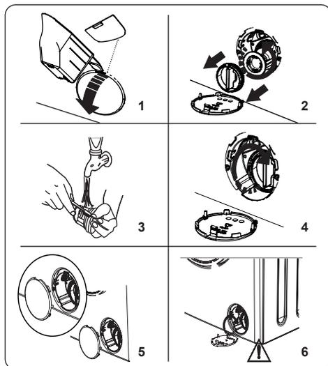
El sistema de filtro de bomba de la lavadora alarga la vida de la bomba al impedir que entren pelusas en la máquina. Recomendamos limpiar el filtro de la bomba cada dos meses.
