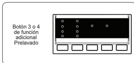
Esta función permite dar un prelavado a ropa muy sucia antes de que se realice el programa de lavado principal. Al utilizar esta función, ponga detergente en el compartimento de lavado delantero del compartimento para detergente.
