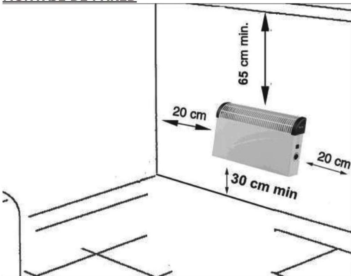
Si se opta por un montaje de pared, entonces no se deberán instalar las patas. Debe elegirse la posición cuidadosamente.
