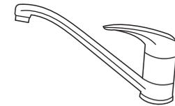
La parte delantera debe ser superior a 10 mm. El extremo de salida del grifo debe ser plana y lisa
