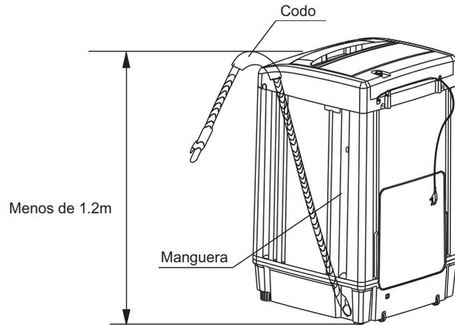
1. La manguera se puede colgar o dejar caída durante el uso, si la tubería de drenaje se cuelga durante el uso, la altura debe ser inferior a 1,2 m.
