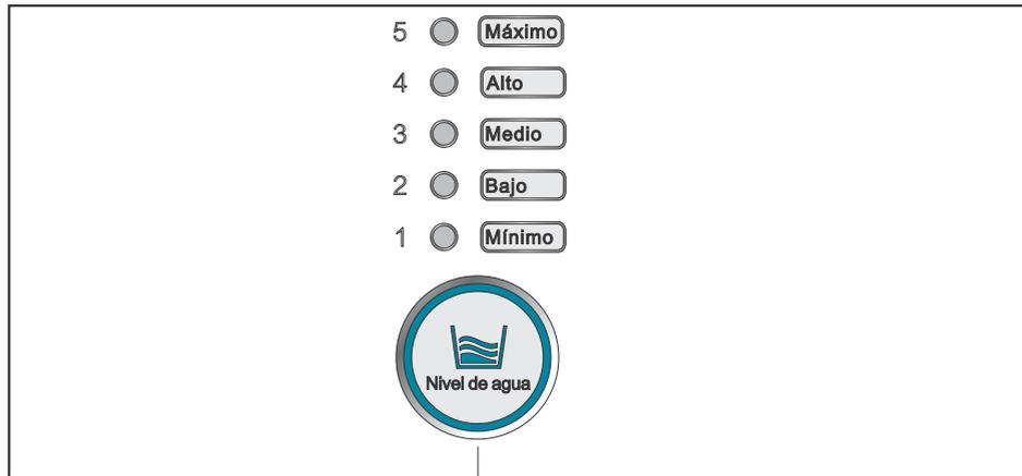
Presione NIVEL DE AGUA para seleccionar el nivel de agua, puede seleccionar el nivel de agua apropiado. De acuerdo con la cantidad de carga de ropa, 1 es el nivel de agua bajo, 2-3 es el nivel de agua medio, 4-5 es el nivel de agua alto
